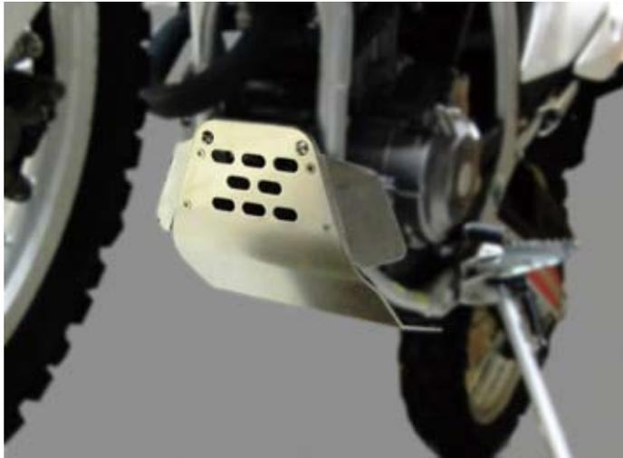
●4mm厚の硬質アルミ A2017で必要な硬さと柔らかさを持たせました。サイドガードも着いた本格的なオフロードでの使用も考慮したアンダーガード。第一弾はホンダ CRF250Lから。
