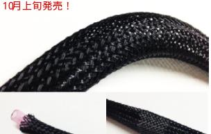
伸縮性に優れ、配線やホースをスムーズに挿入しやすい構造。圧縮すると内径が 2倍以上に広がるため、内部にコネクターなどが有った場合でもフィットさせること が出来ます。ナイロン系の複合糸で編まれているために、耐摩耗性に優れています。 使用用途に合わせ 4サイズを設定。また内径に合わせた用途を考慮して長さを設定。 配線・ホース・ワイヤーの保護に最適。耐熱 -70 ~ +125 。
