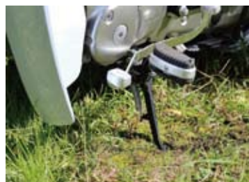
地盤の柔らかい場所での駐輪は 転倒してしまう等のリスクが存在します
