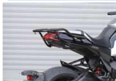
●積載量が少ない新型カタナの積載量を一気にアップする定番アイテム。車体デザインを壊さずにツーリングや街乗りでの使いやすさをアップするスタンダード形状の天板を採用。インナーパーツでキャリアを固定する事で外観を大きく変えずに装着出来る様になりました。
