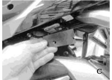
1. シート下側にあるフレームプレートの車体左側のボルト2本を外します。 (写真A, B参照)
