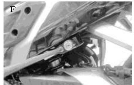
3. 2でステーをあてがった所に付属ボルト④で固定します。 (写真D, E参照)
