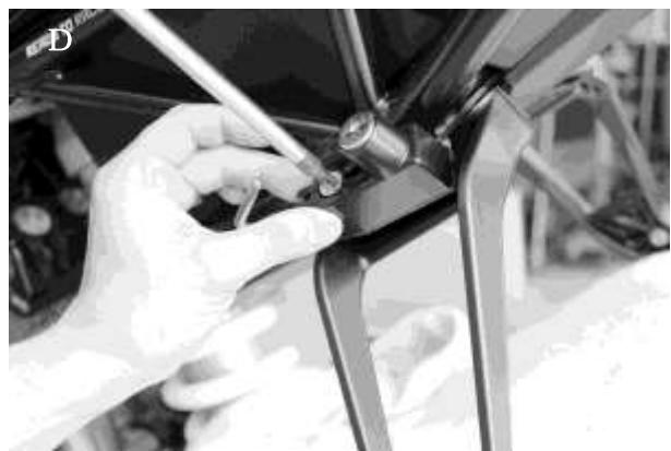
3. 2でボルト③を通した純正ブラケットとフレームの間にステー①を挟み込んで取付け、本体④を付属ボルト⑤で組付けます。
