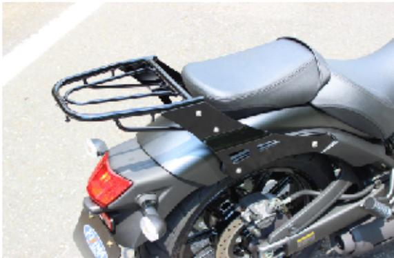
積載能力の低いバイクで重宝するリアキャリアが登場！ サイドプレートとの組み合わせタイプなので取付も簡単。また弊社製バックサポートとの組み合わせも考えており、街乗りからツーリングまで対応できる優れたもの。スチール製ブラック仕上げ。最大積載量：5kg
