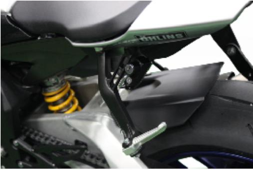
サーキットでの走行をイメージしたスーパースポーツ R1に実際の使用での便利アイテムのヘルメットロックを装着。左タンデムステップに違和感なく装着。スチール製ブラック仕上げ。
