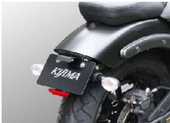
リア周りをスッキリ見せ、カスタム度を一気にアップさせるテールランプキットフェンダーレスタイプが登場！ LEDナンバー照明 /スリムタイプリアレクター /LEDテールランプ (スモーク)が付属。純正ウインカー対応。スチール製ブラック仕上げ。
