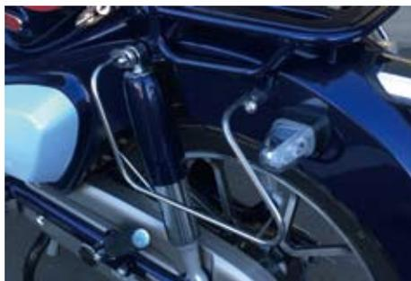
●サイドバッグを取り付ける際に巻き込み防止になるバッグサポートにスーパーカブC125用が新たにラインナップ！車体のイメージを保ちつつ機能面で効果を発揮。単体でもドレスアップ効果が高いメッキ仕様。使い勝手やカスタムに合わせて左右セットと左右それぞれ単品で設定。●スチール製クロームメッキ仕上げ
