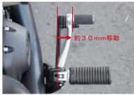
●ブレーキの操作性を向上させるため、ペダル部を外側へオフセットさせたブレーキアーム。純正ブレーキペダルに比べ、 ペダル面が約20mmアップ、約30mm 外側ヘオフセット。 ペダル部分もカスタムが出来るようにシフトペグ(5/16-24)が装着 出来るように設定。
