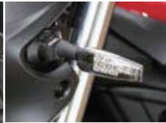
●スリムな形状に8個のLEDを組み込み確かな発光をします。左右ウインカー、ウインカーベース、配線をICリレーを全てセット。簡単にLEDへの組み換えが行えます。
