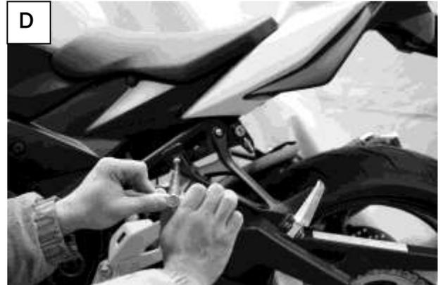
3. 付属ボルト⑤でタンデムブラケットを固定して下さい。 写真D参照
