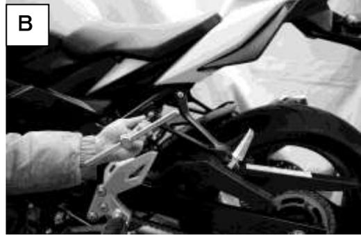
1. 進行方向左側のタンデムステップブラケットを外します 写真A、B 参照
