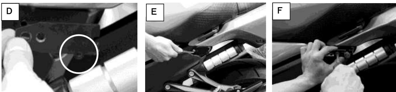
3. ステア①の回り止め凸部をフレーム凹部にはめ込み、付属ボルト②でフレームネジ穴に固定します
