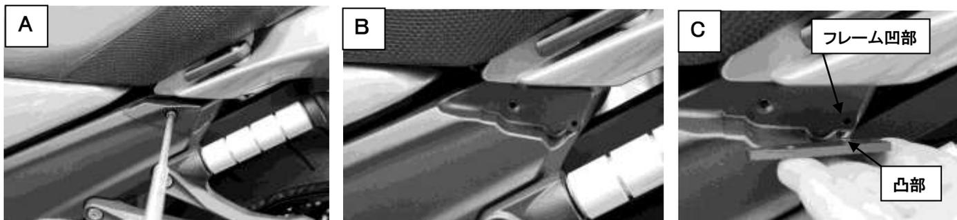
1. 進行方向左側のタンデムステップブラケット上にあるフレームカバーを外します
