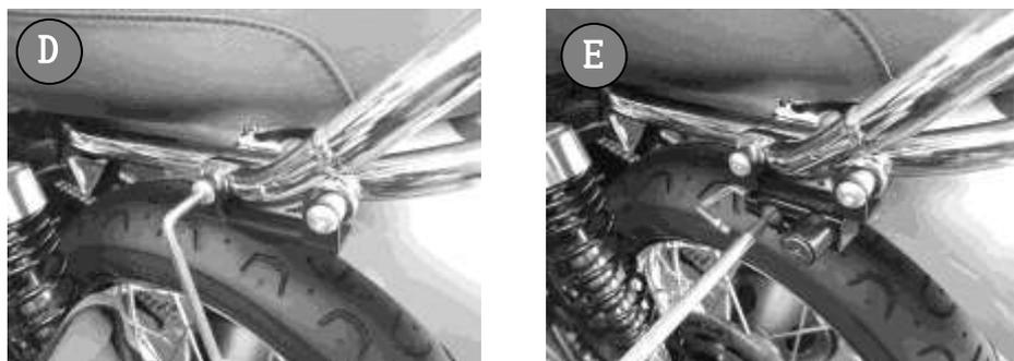
3. 2でセットしたステー本体②のカラーを取外したグラブレール左側のボルト部の凹みに収め、セットしたボルトを締め付け固定、緩めたグラブレール右側ボルトも締め付け固定します。(写真 D 参照)
