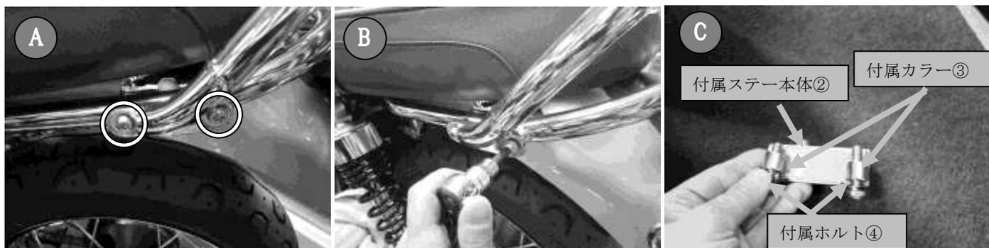
1. 車体左側の純正マウントレールとグラブレールを固定しているボルトを外します。(写真 A,B 参照)
